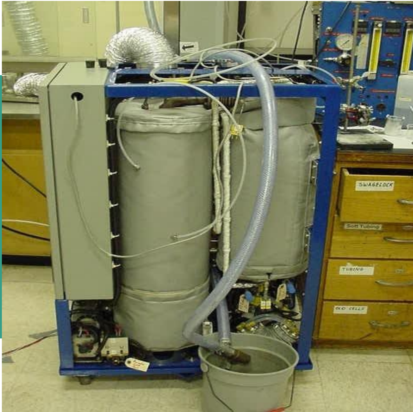
Reformador de gas natural
